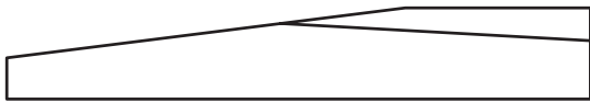
وسیله صاف کردن سیم‌ها در داخل شیار و از بین بردن فضای مرده در شیارها
