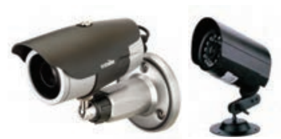
شکل ۳-۵۱ دوربین‌های نصب شده روی انواع پایه‌های ثابت
