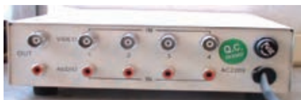
شکل ۳-۶۰ قسمت‌های مختلف پشت سویچر
