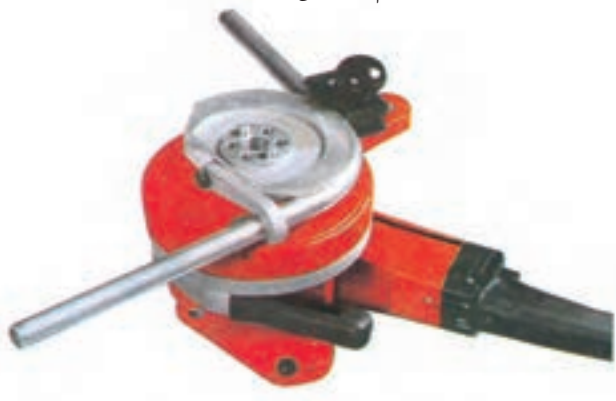
شکل ۴-۶ — لوله خم کن دستی با دو نمونه شابلون مربوطه
