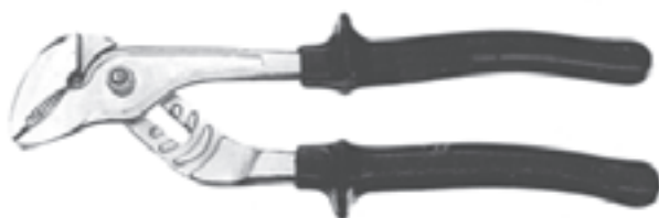
شکل ۱۰-۴ - دو نمونه آچار کلاغی
