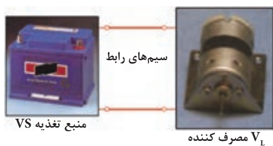
شکل ۵-۹۶ افت ولتاژ بین مولد و مصرف کننده
