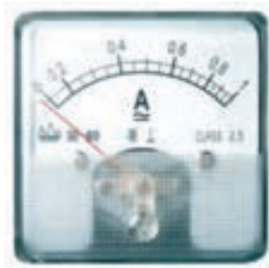
شکل ۳-۹- شکل ظاهری یک نمونه آمپر متر
