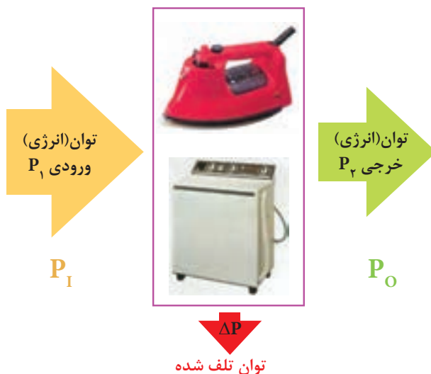
شکل ۶-۲۳- بلوک دیاگرام توان ها
