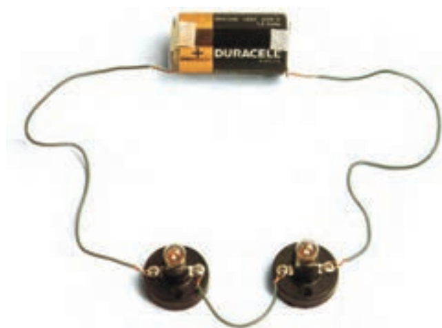
شکل ۵-۳- مدار واقعی دو لامپ به صورت سری
