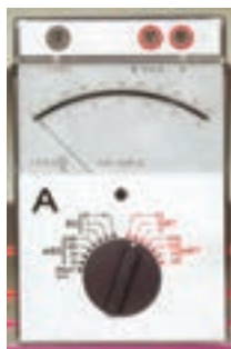
شکل ۵-۲۴- یک نمونه آمپر متر آزمایشگاهی
