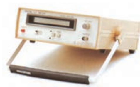
شکل ۵-۲۹ یک نمونه CL متر
