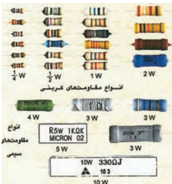
شکل ۱۷-۶- استانداردهای توان در مقاومت ها
