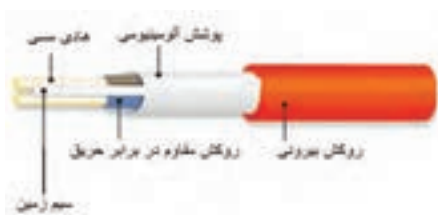
شکل ۲۴-۱ قسمت‌های مختلف یک کابل اعلام حریق
