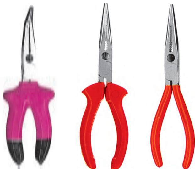
الف - دم باریک دسته عایق ب - دم باریک دسته عایق ج - دم باریک دسته عایق عایق معمولی نوک گرد فشار قوی با نوک بلند فشار قوی با نوک کج ۴۵°
