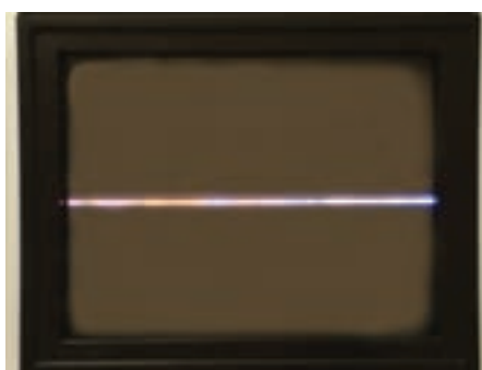
شکل ۲-۴۰- نوسان ساز عمودی از کار افتاده است.
