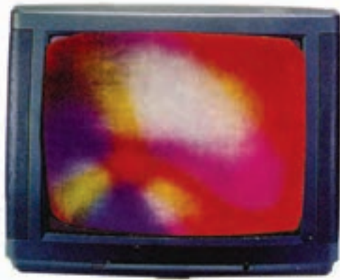
شکل ۸۰-۱- عدم ایجاد خلوص رنگ
