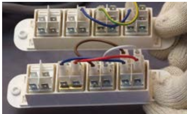
روی دیگر کلیدهای انتخاب سرعت موتور در هود زیر کابینت شکل ۷۳-۱
