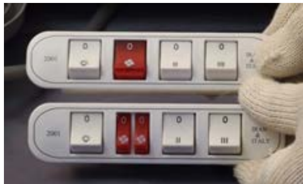
کلید فن دور بالا (۳) هر دو موتور، کلید فن دور متوسط (۲) هر دو موتور، کلید فن دور کم (۱) موتور شکل ۷۲-۱
