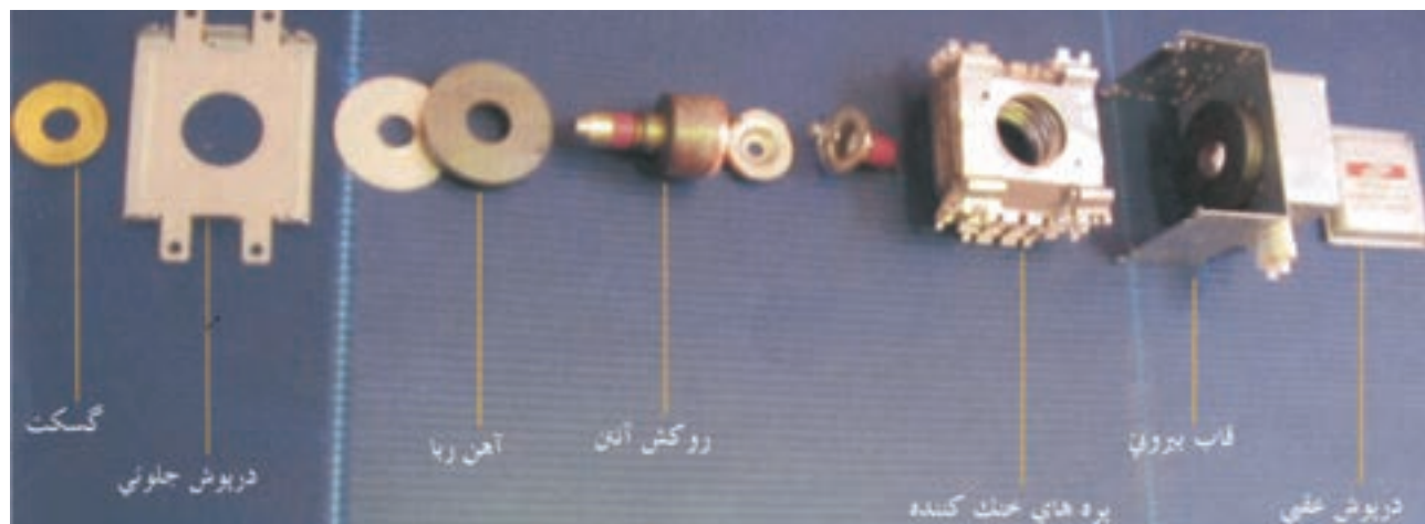
شکل ۳-۹۶ نقشه‌ی انفجاری قطعات یک مگنترون
