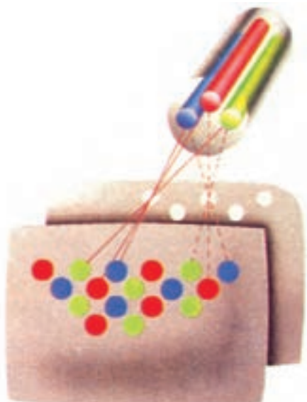
شکل ۱-۲۰ تفنگ الکترونی لامپ تصویر مثلثی ( \Delta )
