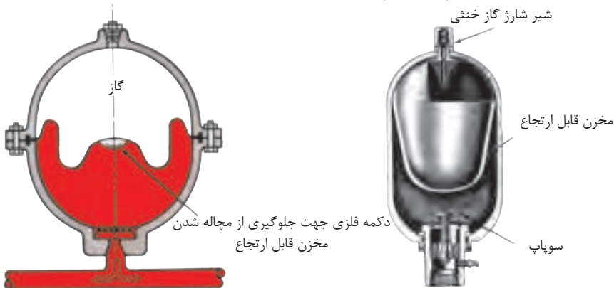
شکل ۴-۱-۱- آکومولاتور گازی نوع دیافراگمی
