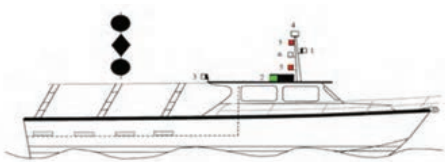
شکل ۳۶-۴- چراغ‌ها و علائم بصری کشتی دارای محدودیت مانور
