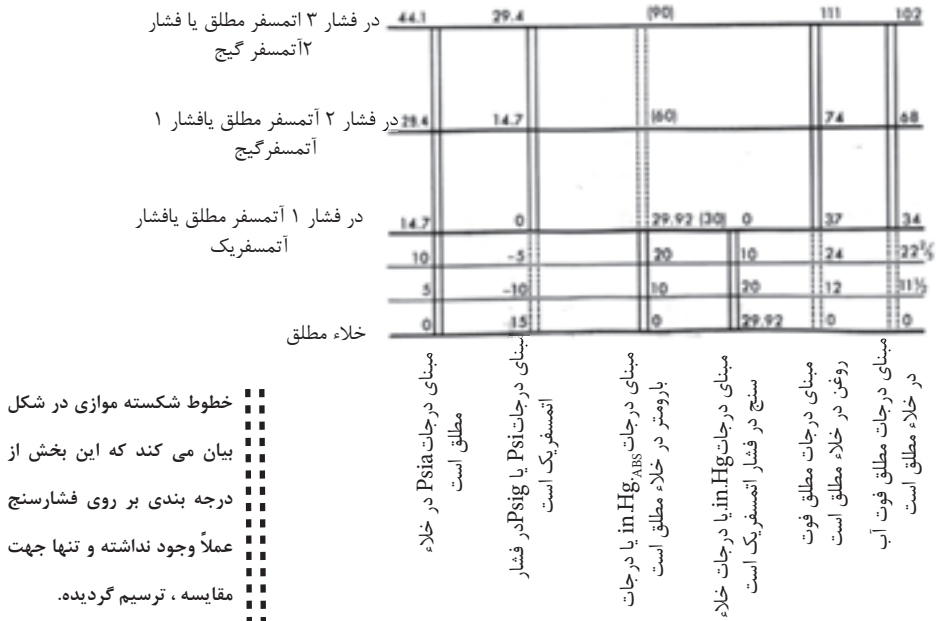
شکل ۱۰-۱- مقایسه فشار و خلاء با واحدهای مختلف
