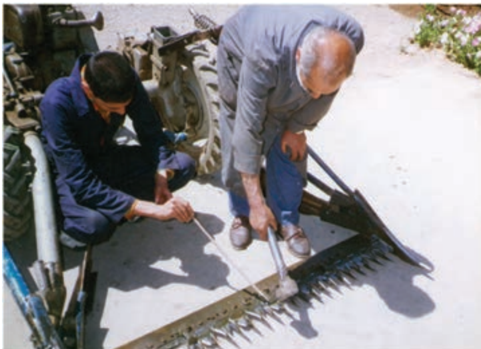
شکل ۲-۷ – استفاده از چکش یک کیلویی جهت تنظیم گیره‌ی تیغه
