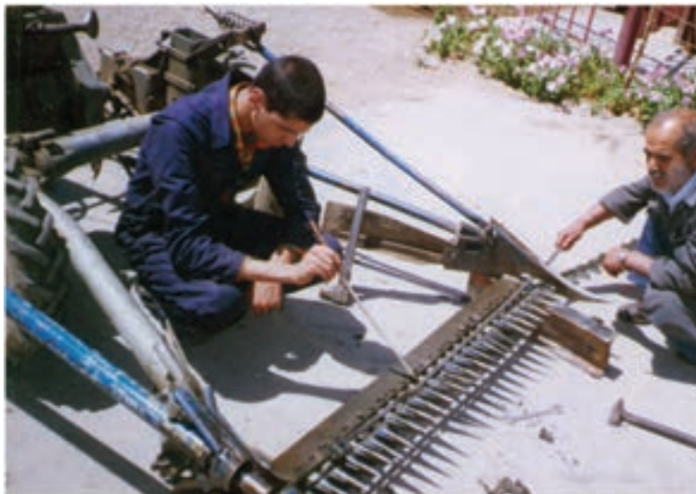
شکل ۵-۲ در شکل، پشت بند تیغه‌ها نشان داده شده است.
