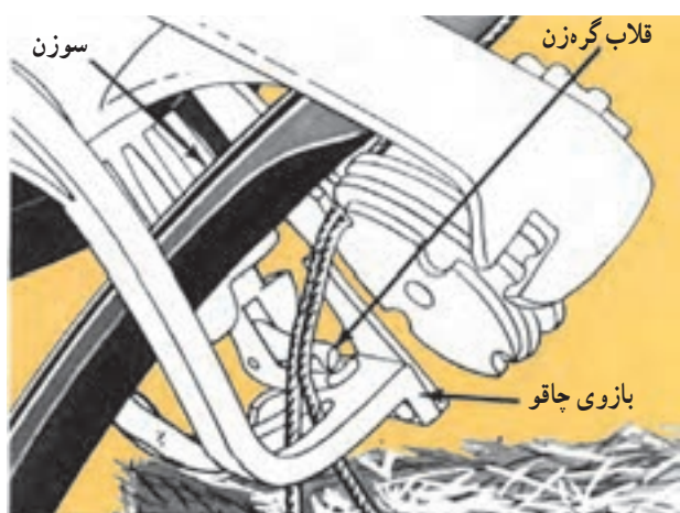
شکل ۲-۳- آغاز سیکل گره‌زنی. سوزن دومین رشته‌ی نخ را در داخل دیسک نخ قرار داده است.
