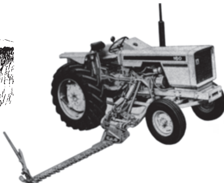
شکل ۱۱-۱- دروگر وسط‌سوار
