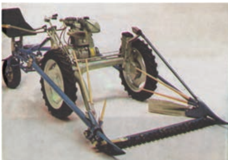
شکل ۶-۱- دروگر شانه‌ای خودگردان
