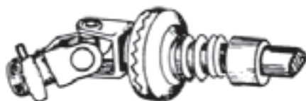
ب - کلاچ در حالت انتقال نیرو
