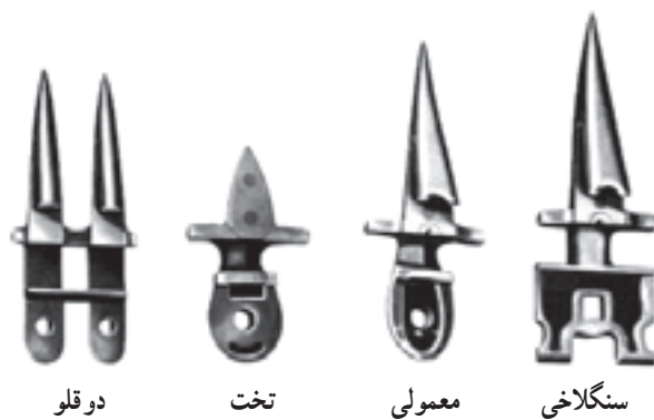
شکل ۱-۳۴- انواع مهم انگشتی‌ها
