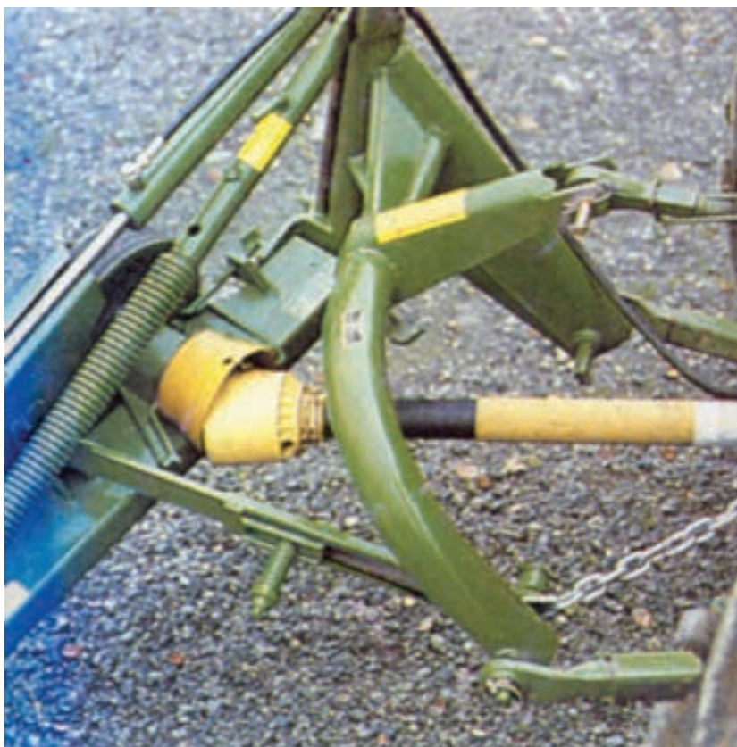
شکل ۱۳-۱۰- اتصال بازوهای تراکتور به دروگر بشقابی
