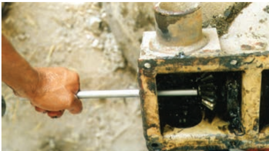
شکل ۹-۷- ضربه از طرف درپوش ۱۱ توسط میله برنجی
