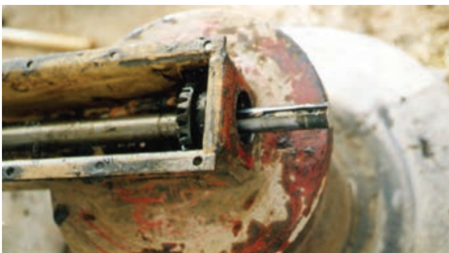
شکل ۱۰-۷- خارج کردن محور افقی از محل درپوش ۴
