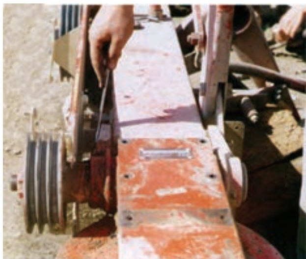
شکل ۱۰-۶ - باز کردن پیچ‌های لولا
