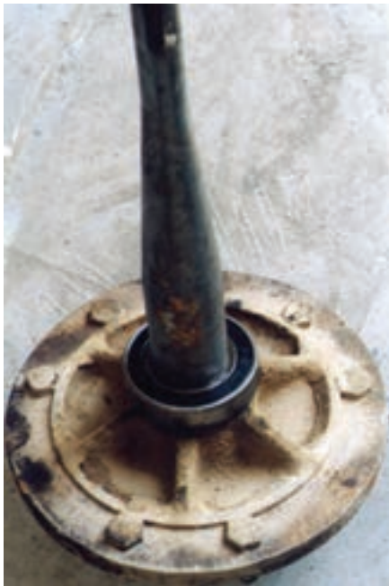
شکل ۱۰-۸- محور استوانه و تویی آن
