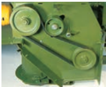
الف - انتقال قدرت با تسمه
