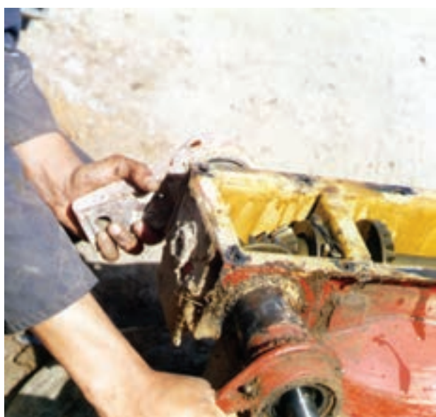
شکل ۱۱-۶ - خارج کردن لولاها
