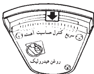
شکل ۱۲-۳- اهرم کنترل حساسیت در تراکتور
