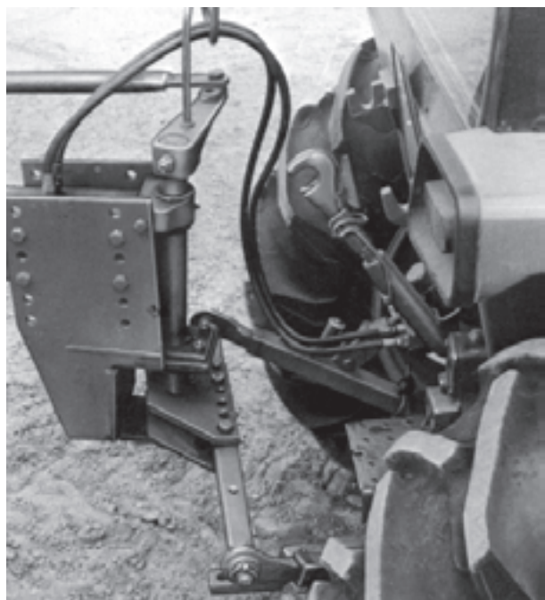
شکل ۲-۷۵- برقراری اتصال بازوها و اتصال هیدرولیکی
