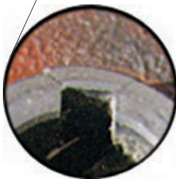
شکل ۱۷-۵- شکستن جا خار
