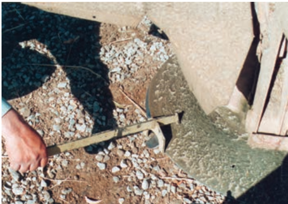
شکل ۱۱-۳- تعویض تیغه
