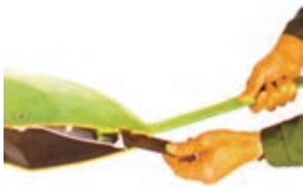
شکل ۱۰-۳- تعویض تیغه
