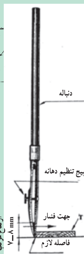
شکل ۱۶-۴ اجزای قلم و اندازه مرکب در قلم
