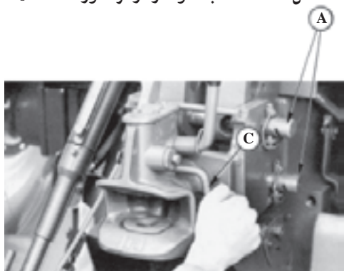
A - پین اتصال مالبند خودکار به تراکتور و خار ضامن C - اهرم آزادکننده پین
