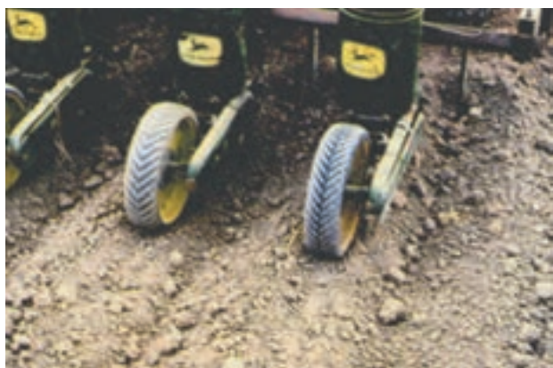
شکل ۵-۳- نحوه تنظیم بذرافشان تراکتوری در اراضی شور
