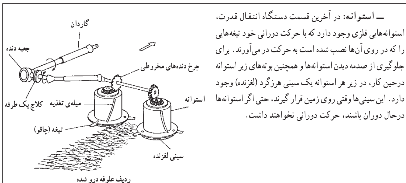
شکل ۱۴-۱- ترتیب انتقال حرکت در یک دروگر استوانه‌ای
