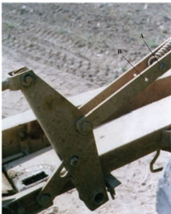
شکل ۲-۱۱- فنر شناور و محل تنظیم آن A - کشش کم B - کشش زیاد
