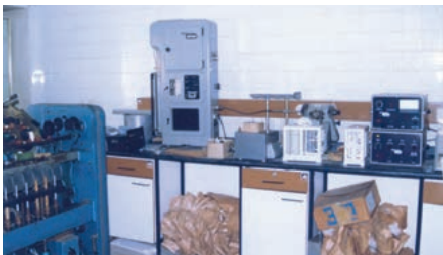
شکل ۲۰-۱- دستگاه اندازه گیری کیفیت و استحکام پنبه
