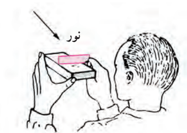
شکل ۱-۲۳- کنترل زاویه قائمه با گونیا
