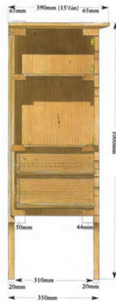
شکل ۵۴ - ۸ برش عمودی از کابینت
