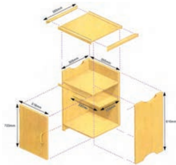
شکل ۳۵-۸ نقشه مونتاز قطعات کابینت
