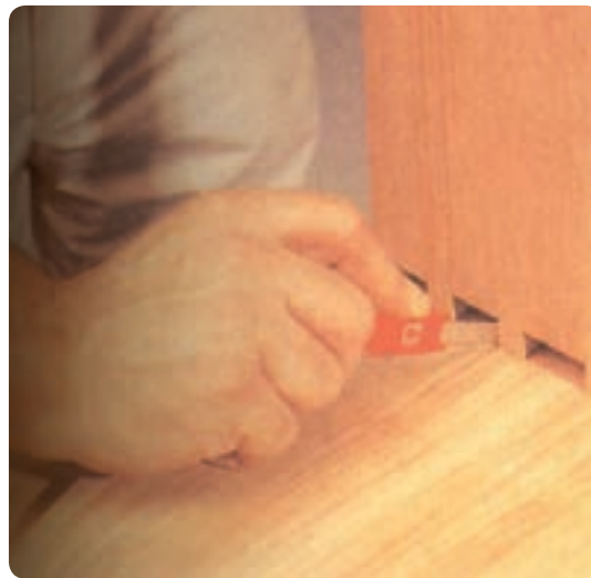
شکل ۶-۱۳۸ خط‌کشی جای فاق روی قطعه دیگر
