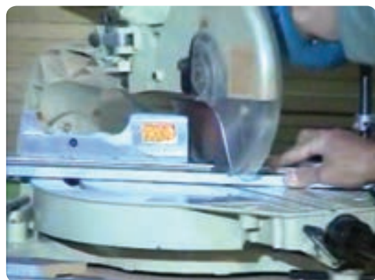
شکل ۶-۹۲ برش پروفیل‌ها با دستگاه فارسی بر
