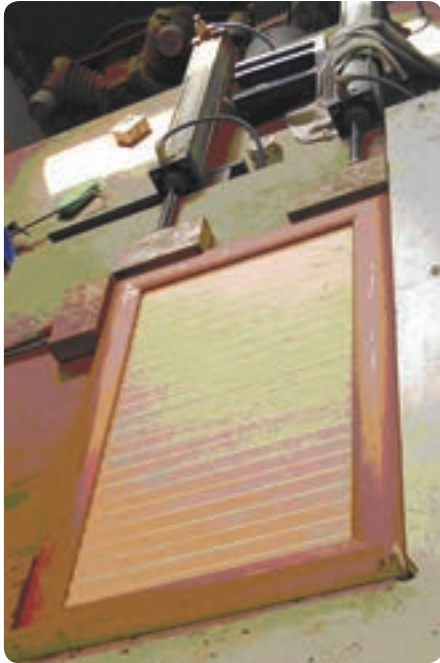
شکل ۶-۹۷ تنگ نیوماتیکی جهت مونتاژ در قابدار کابینت
