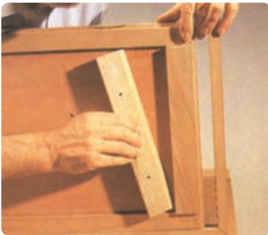
شکل ۱۴۴-۶ اتصال قید کمکی جهت نصب روی دیوار
