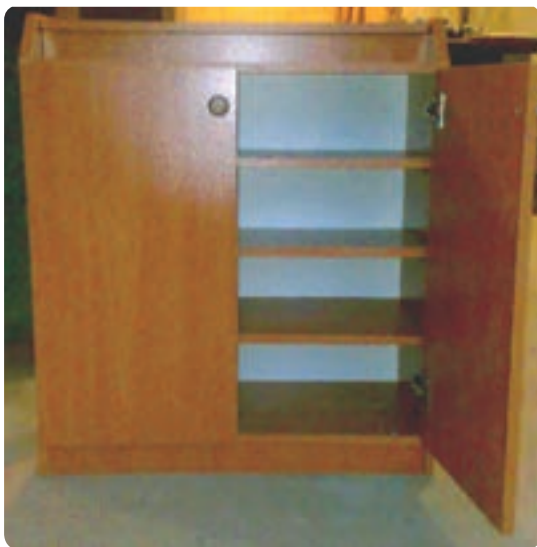
شکل ۱۳۲-۶ نصب يراق آلات در کابینت جاکفشی
