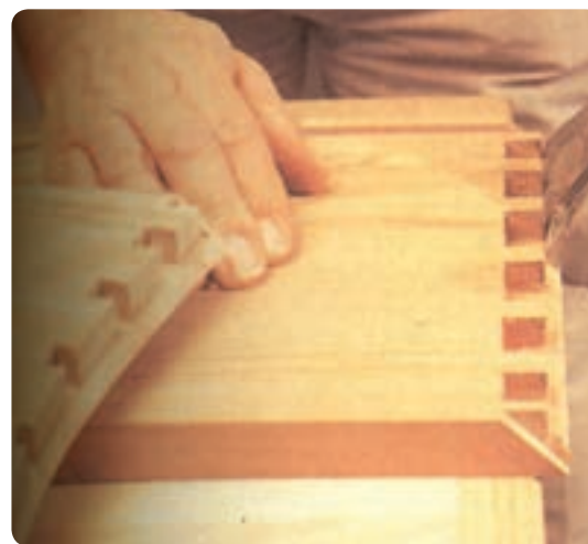
شکل ۶-۱۳۹ پرداخت لبه دو راهه شده بدنه کابینت با رنده بغل دو راهه
