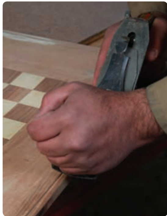
شکل ۷۹-۶ رنده کردن زهوار چوبی
