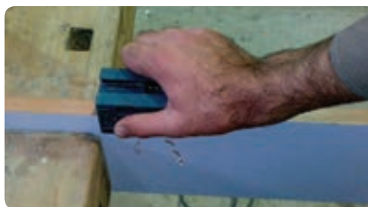
شکل ۸۲-۶ پرداخت لبه اضافی روکش
