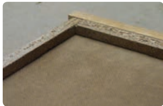
شکل ۶-۱۰۳ کف جعبه در کنشکاف بدنه جعبه و در جعبه
