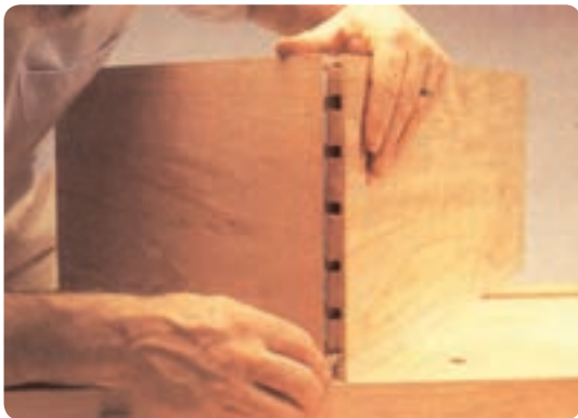
شکل ۶-۱۴۰ مونتاژ آزمایشی قبل از چسب زدن قطعات
