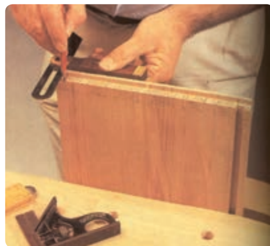
شکل ۶-۱۳۶ خط‌کشی اتصال دم‌چلچله دورو مخفی
