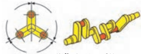
میل لنگ موتور شش سیلندر V شکل
