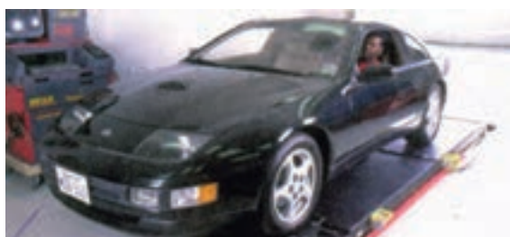
شکل ۳-۲۱۹ - دستگاه اندازه‌گیری زوایای رایانه‌ای (کامپیوتری)
