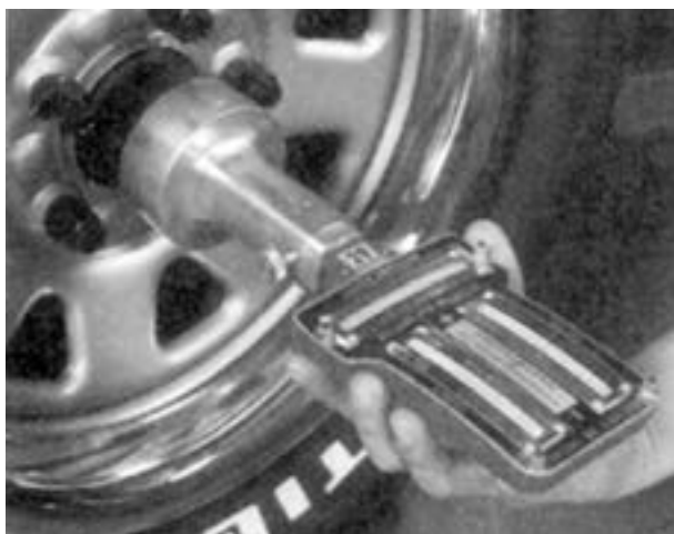
شکل ۲۱۷-۳- دستگاه اندازه‌گیری زوایای مکانیکی (ترازی)
