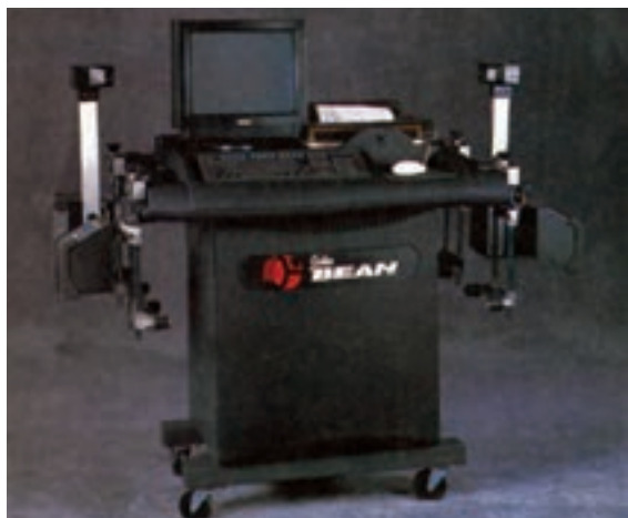
شکل ۳-۲۱۸ - دستگاه اندازه‌گیری زوایای نوری
