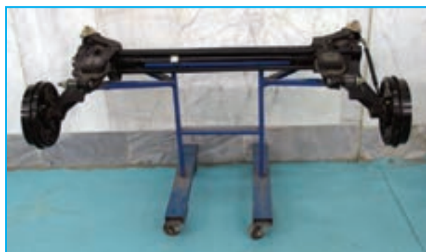
شکل ۳-۱۵۹- مجموعه تعلیق عقب
