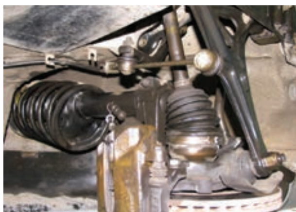
شکل ۱۳۱- نصب میل موج گیر کوتاه
