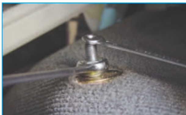
شکل ۳-۶۳- باز کردن مهره اتصال بالای کمک فنر
