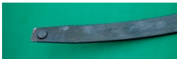
شکل ۳-۷۰- لاستیک‌های محافظ انتهایی لایه‌های فنر شمش
