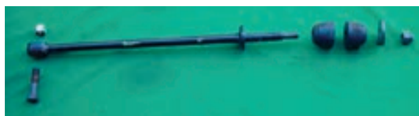
شکل ۳-۸۴ اجزای میل تعادل
