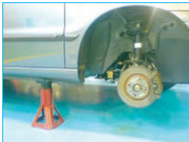
شکل ۳-۶۱- خودروی مستقر بر پایه قابل تنظیم
