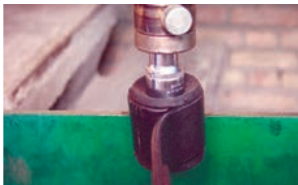
شکل ۳-۶۹- بوش لاستیکی فلزی محل اتصال شاه فنر
