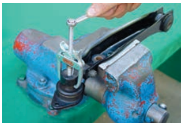
شکل ۳-۸۵ جدا کردن سیبک از بازوی اتصال
