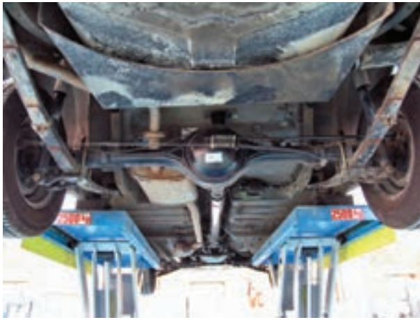
شکل ۳۱۵- دیفرانسیل در خودرو محرک عقب
