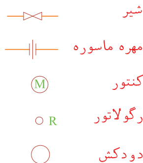
شکل ۴-۵ علائم اختصاری نقشه کشی گاز
