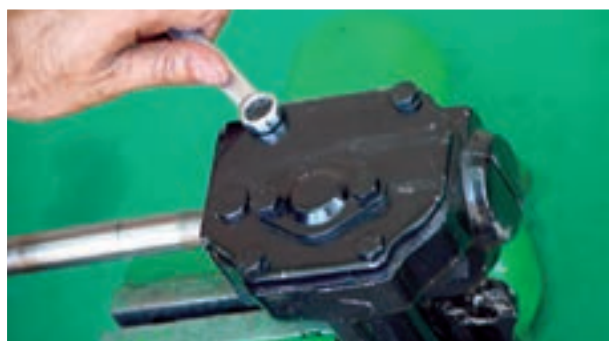
شکل ۲-۶۲ باز کردن درپوش بالایی جعبه فرمان
