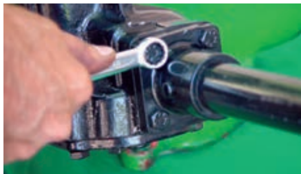
شکل ۲-۶۰ باز کردن پیچ‌های لوله فرمان
