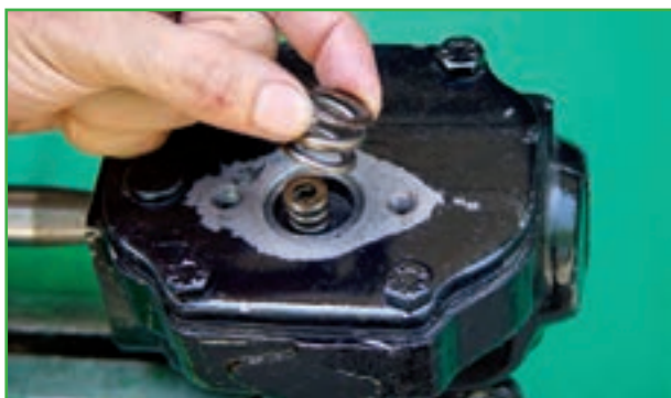
شکل ۲-۶۱ خارج کردن فنرها
