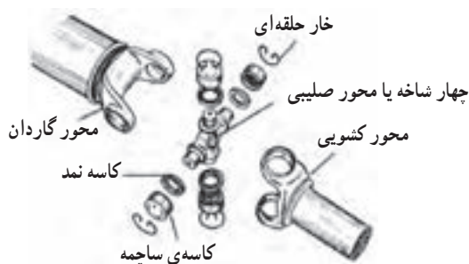
شکل ۲۹۱- اجزای قفل گاردان
