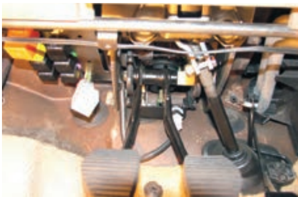
شکل ۱۵۲- کلید چراغ ترمز
