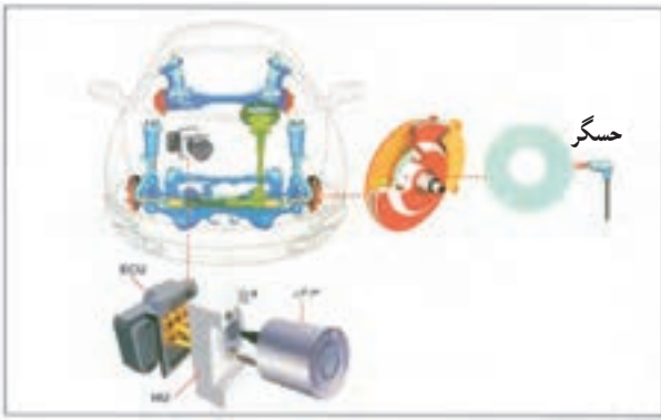
شکل ۱-۱۵۷- اجزای سیستم ترمز ضد قفل (ABS)
