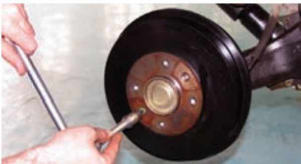
شکل ۱-۸۹ – باز کردن پیچ کاسه چرخ
