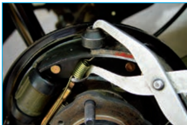
شکل ۹۱-۱- خارج کردن فنر بالایی
