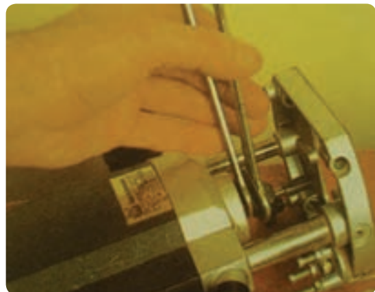
شکل ۲-۴۲ باز و بسته کردن تیغه به کمک دو آچار تخت
