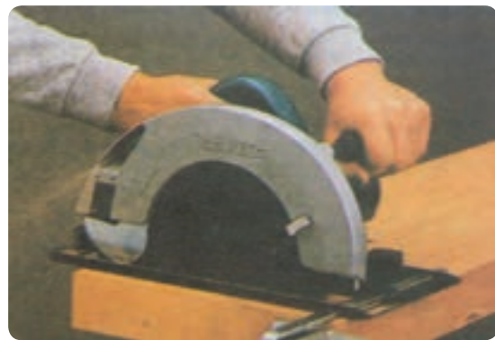
شکل ۲-۳۶ برش به وسیله گونیای دستگاه
