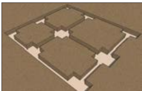
شکل ۱-۸۰ پی‌کنی متناسب با ابعاد مشخص شده‌ی پی در نقشه روی زمین اجرا می‌شود.
