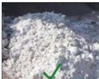
شکل ۱-۳۰ آهک سرنده (الک شده) و آماده برای ساخت شفته
