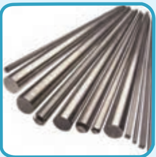
شکل ۱۶-۱- میلگرد با رویه صاف
