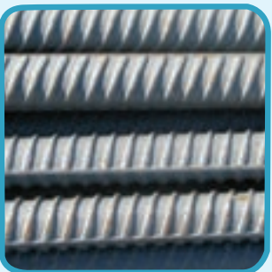
شکل ۱۷-۱- میلگرد با رویه آجدار
