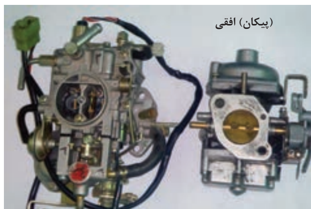
شکل ۱-۶۴ کاربراتورها از نظر حرکت سوخت (نزولی - افقی)
