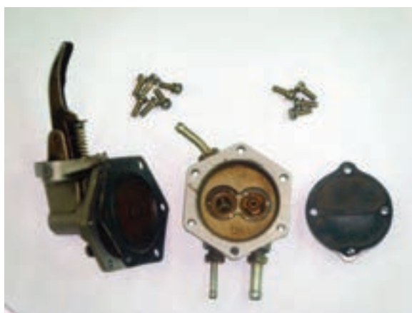
شکل ۱-۴۳ اجزای پمپ سوخت
