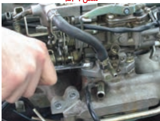
شکل ۱-۱۱۰ باز کردن پیچهای اتصال کاربراتور به موتور
