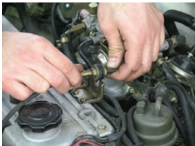
شکل ۱-۱۱۵ پیاده کردن کاربراتور
