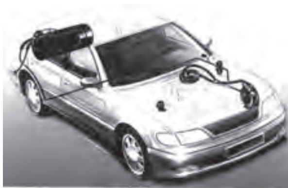
شکل ۱۴-۱ سیستم سوخت رسانی گاز خودرو
