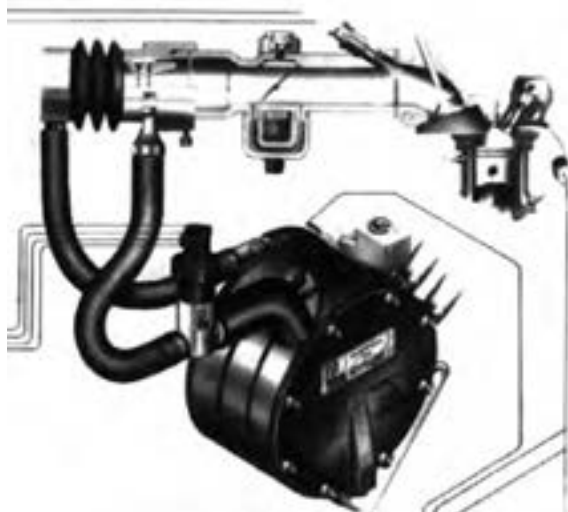
شکل ۱۵-۱ سیستم مخلوط کننده سوخت گاز با هوا
