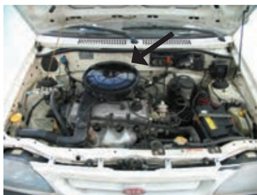
شکل ۵۰-۱ هواکش موتور کاربراتوری
