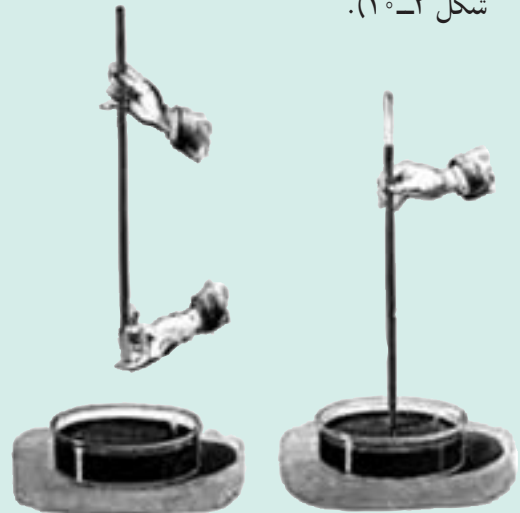
شکل ۳-۸ - تهیه بارومتر جیوه‌ای
