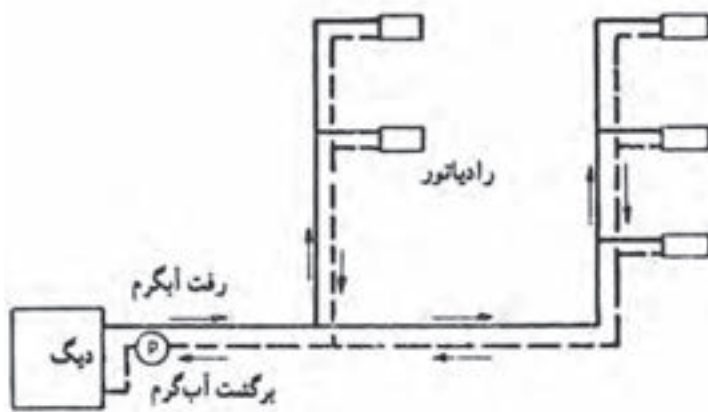
▲ شکل ۹-۳- حرارت مرکزی با آب گرم
