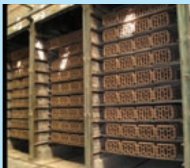
گرم‌خانه برای خشک کردن خشت‌ها و سفال‌های خام
