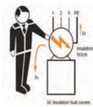
(ب) تماس با بدنه فلزی دستگاه که اتصال بدنه پیدا کرده
