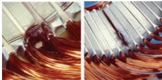
شکل ۲-۲- اتصال سیم های حامل جریان با بدنه فلزی یک موتور الکتریکی
