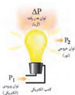
شکل ۱-۵۵- توان و تلفات در لامپ معمولی
