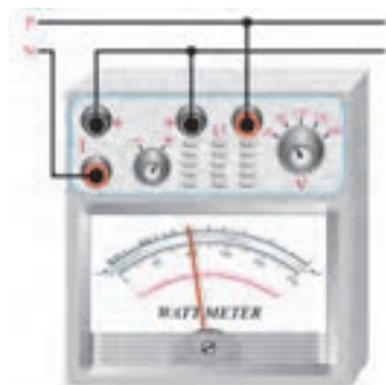
شکل ۱-۵۲ – روش بستن وات متر در مدار
