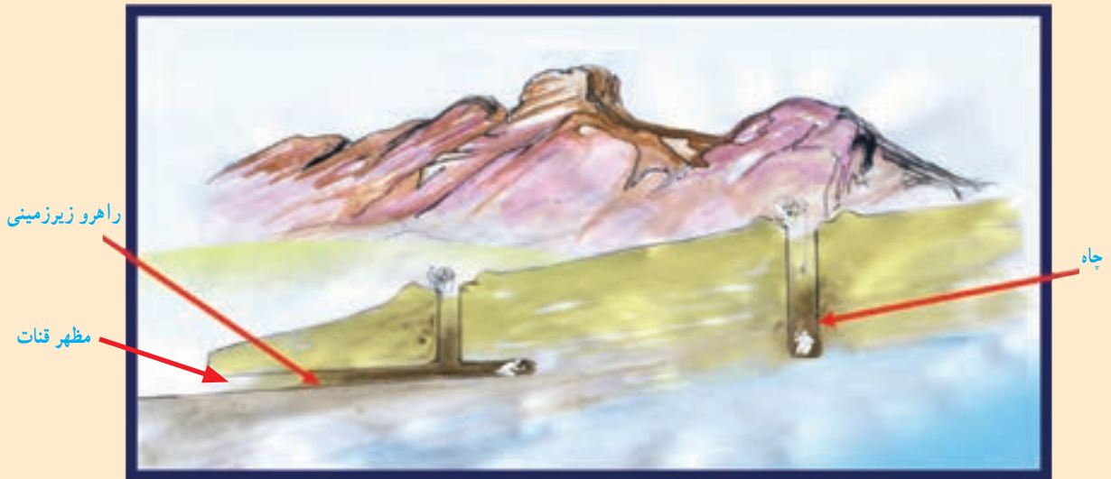
شکل ۳۰-۱- نیم‌رخ از ساختمان یک قنات به‌عنوان یکی از سازه‌های عجیب جهان
