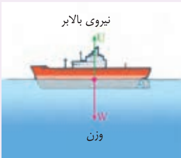
شکل ۶-۲۳ نیروی بالابر دقیقاً برابر وزن کشتی است و کشتی به صورت شناور روی آب باقی می‌ماند.
